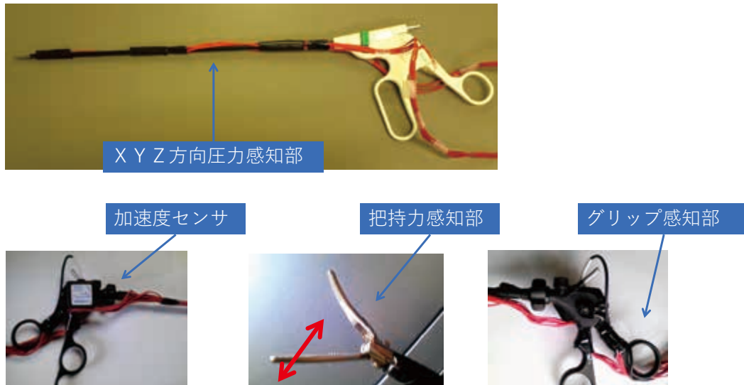
図11 センサーを取り付けた腹腔鏡手術鉗子。数値は手術画像と共にリアルタイムに表示記録される
